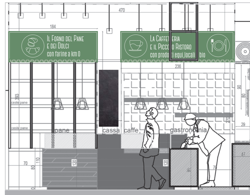
STANZA 1 - parete 4, lato panetteria/caffetteria - h.393 cm Poster pane 184 x 70 cm - verniciatura nero come lavagna fino all'altezza delle piastrelle - Poster caffè 236 x 70 cm
